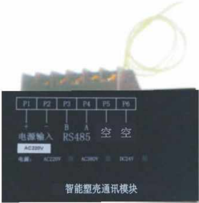
智能型报警不脱扣模块接线图
